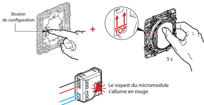
Tout en maintenant l'appui sur le bouton configuration, appuyez sur le haut du bouton de la commande sans pile, sans fil pendant 5 secondes.
