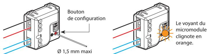
**2** Appuyez de **façon prolongée** (1 à 2 secondes maxi) sur le bouton de configuration du micromodule avec un outil (Ø 1,5 mm maxi), jusqu'à ce que le voyant s'allume brièvement en bleu, puis relâchez l'appui.
