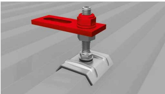
Poser et orienter la tôle d'adaptation et monter les autres rondelles de support avec l'écrou de fixation. La hauteur de la tôle d'adaptation est fixée via les deux écrous. En utilisant la clé six pans, assurez-vous que la fixation de panneaux solaires ne vrille pas. Après la fixation correcte des deux écrous, visser et serrer.
