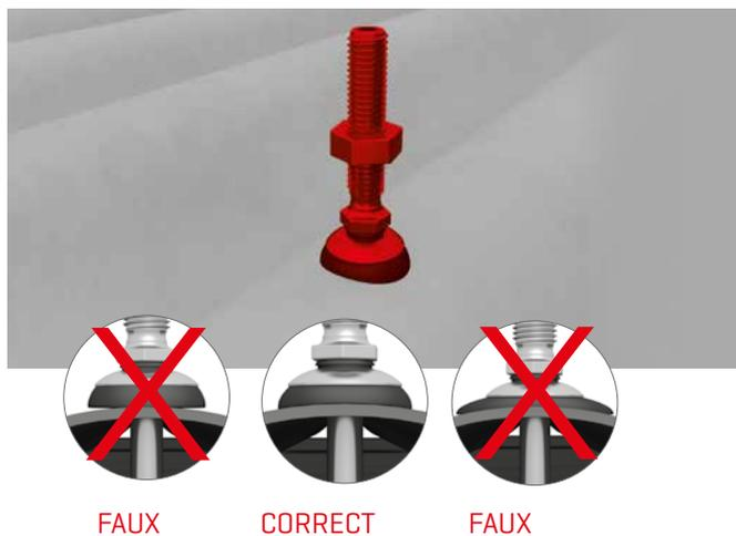
**Informations supplémentaires :** La vis à double filetage ne doit pas être serrée au-delà du couple de serrage, la rondelle d'étanchéité doit être légèrement comprimée et être appliquée sur l'ensemble de la surface.
