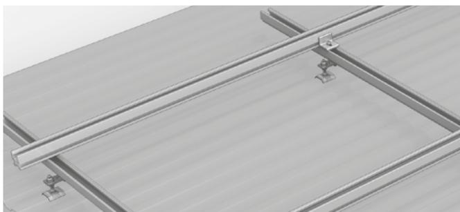
Fixer à l'aide du Climber le CrossRail ou le SingleRail en tant que rail supérieur suivant le schéma ci-dessous. L'écartement des rails se fait en fonction des résultats du logiciel de calcul.
