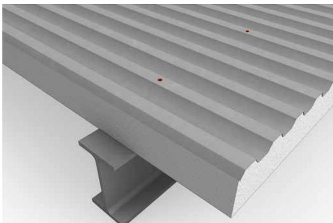
Mesurer les intervalles entre les vis en fonction de la statique ou de K2 Base. Vérifier la position des pannes et pré-percer les panneaux en passant au travers des pannes.
