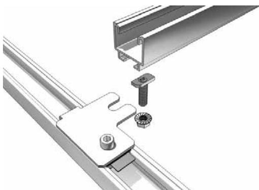
Fixer le SolidRail supérieur à l'aide de la vis à tête marteau et de l'écrou à embase.
