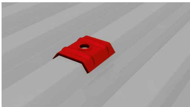
Avant le montage de la fixation de panneaux solaires, veuillez nettoyer la surface et retirer tout copeau de perçage. En cas de fixation de panneaux solaires pour des panneaux de profilé métallique, poser la calotte sur le trou percé. [En cas de fixation de panneaux solaires pour des panneaux de profilé de fibrociment, la rondelle d'étanchéité est déjà montée sur la fixation de panneaux solaires].
