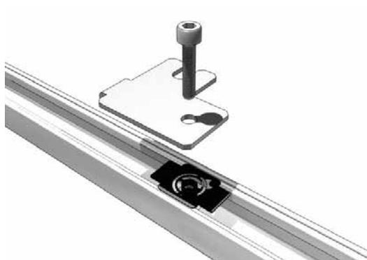
Mettre l'écrou MK2 dans le rail SolidRail inférieur, poser le kit connecteur d'angle sur le SolidRail et fixer à l'aide de la vis à tête cylindrique.
