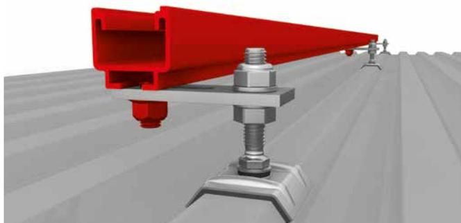
Faites attention à ce que la vis à tête marteau soit correctement placée. Tourner la vis à tête marteau de 90 degrés dans le sens inverse des aiguilles d'une montre après l'avoir introduite dans la cavité inférieure du rail. Le rail de support projeté K2 Solid est fixé à la tôle d'adaptation avec une vis à tête marteau M 10 et un écrou denté.
