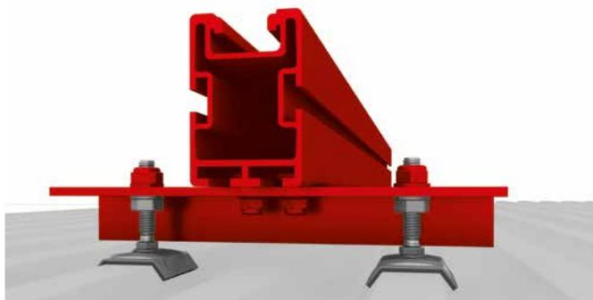
Le K2 Bridge est monté à la place de la tôle d'adaptation sur deux fixations de panneaux solaires. Cela permet de réaliser des envergures plus importantes. En fonction du type de rail, celui-ci est fixé sur le Bridge par une ou deux vis à tête marteau M10x30.
