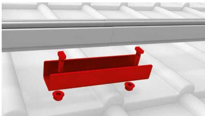
Poser les rails bout à bout et assembler à l'aide du connecteur de rails et des 2 vis à tête marteau et écrous à dents. Le joint entre les rails ne doit pas être situé dans la zone du crochet de toit.
