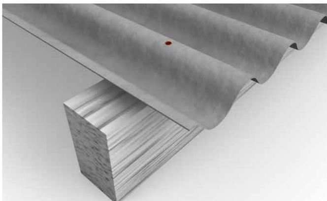
Mesurer les intervalles entre les vis en fonction de la statique ou de K2 Base. Vérifier la position des pannes et pré-percer les pannes en passant au travers du profilé en fibrociment.
