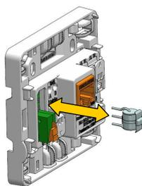
Si besoin, remplacer l'éclateur à gaz 260V à l'aide d'une pince à bec fin
