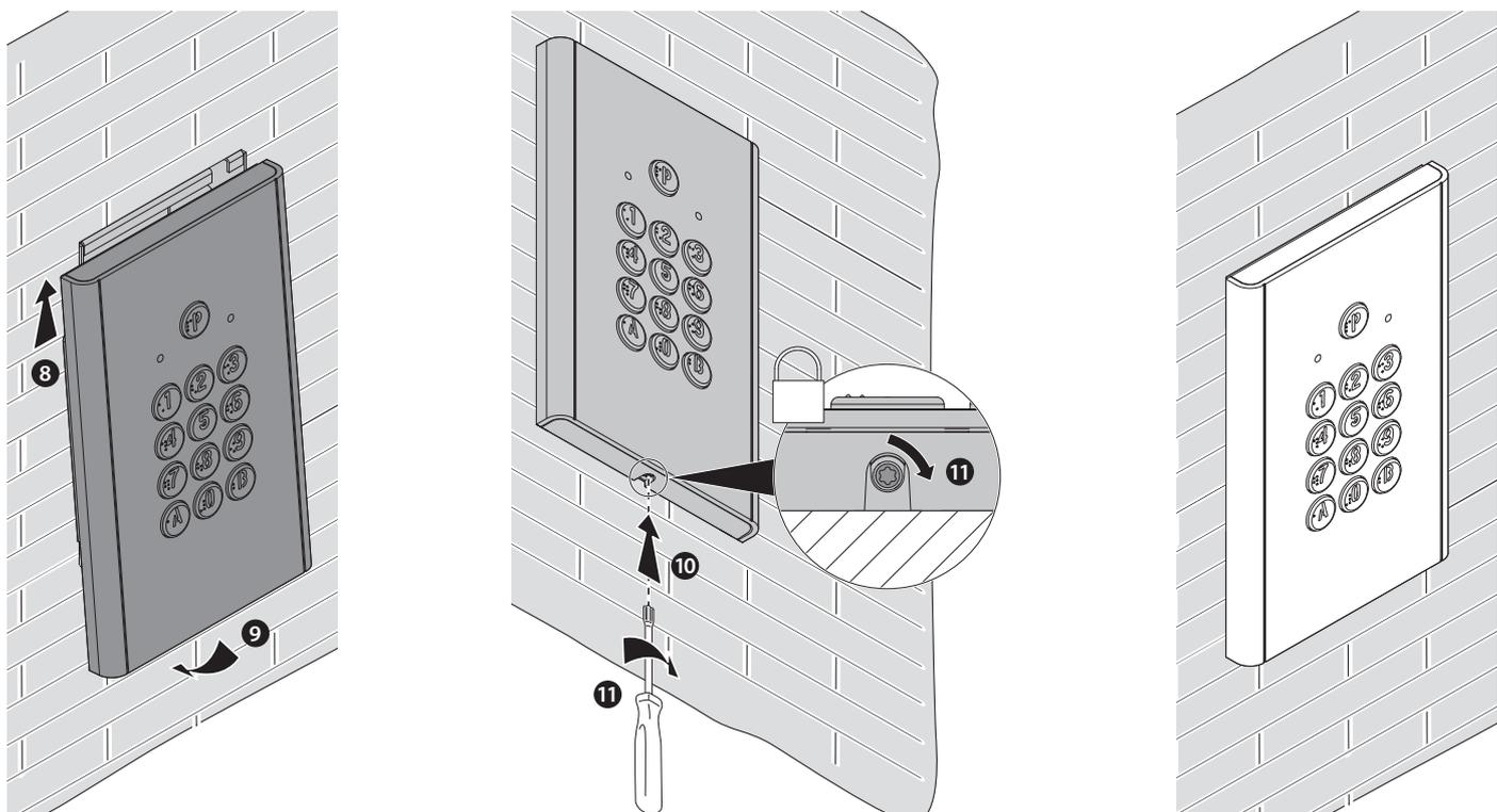
Lors de la pose de l'interphone, si le mur est abîmé ou si la surface n'est pas suffisamment plane, appliquer du silicone pour assurer l'étanchéité.
