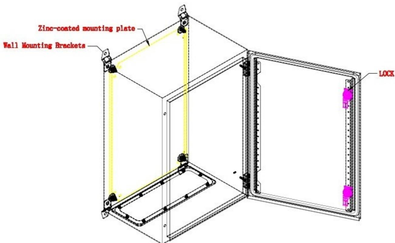
**Application :** un coffret mural industriel IP66 en acier doux qui convient pour abriter l'équipement électronique et électrique dans les environnements exigeants, où ils risquent d'être exposés à un lavage au tuyau fréquent ou à des conditions généralement humides.
