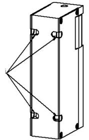
Acheminer les câbles vers le trou de sortie le plus proche du point de connexion de l'installation électrique.
