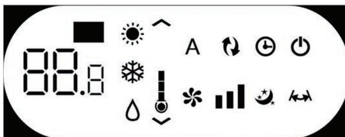
L'écran affiche normalement l'état de fonctionnement (voir paragraphe Description du fonctionnement) et les alarmes éventuelles (voir paragraphe Affichage des alarmes à l'écran). De plus, la pression des différents symboles permet de sélectionner les différentes fonctions.
