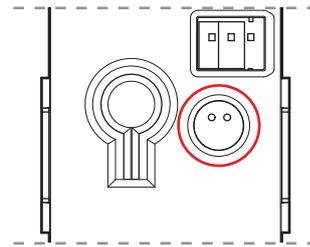
Utilisez le potentiomètre pour définir le temps d'ouverture de la porte entre 0,2 et 60 secondes.
