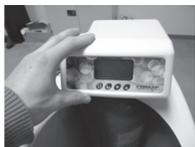
L'électrode est branchée électriquement, il ne reste plus qu'à la relier hydrauliquement sur le tube d'aspiration de la saumure.
