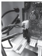
Connecter l'électrode sur la gauche de la carte électronique.
