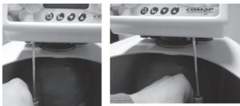
Sous la face avant de la tête se trouvent 2 encoches permettant son maintien. Les pousser avec un petit tournevis plat.
