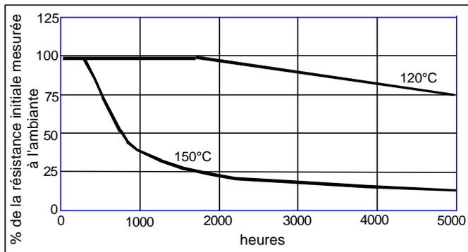
**Résistance aux produits chimiques, vieillissement dans les conditions indiquées et mesure après retour à 22°C.**
